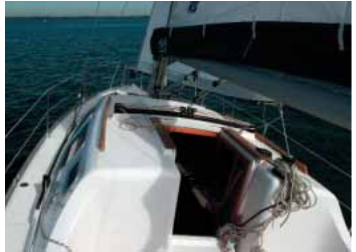
Der Traveller ist vor dem Niedergang montiert. Das spart Platz in der Plicht und erlaubt trotzdem eine halbwegs effektive Großsegelführung
